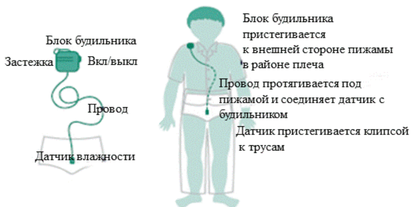
Рис. 14. Схема работы энурезного будильника
